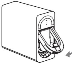
4. Setzen Sie einen neuen Filter ein und drücken Sie den Verriegelungsgriff nach unten (Sie müssen fest mit den Händen drücken).
