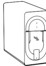
3. Wenn Sie ein Klicken hören und der Verriegelungsgriff an Ort und Stelle bleibt, ist der Filter fest eingesetzt. Das Schloss, der Verriegelungsgriff und das Front-End müssen auf derselben vertikalen Linie sein.
