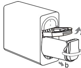
2. Ziehen Sie den Verriegelungsgriff (a) nach oben und benutzen Sie den Filtergriff zum Herausziehen des abgelaufenen Filters (b).
