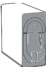
6. Setzen Sie einen neuen Filter ein und drücken Sie den Verriegelungsgriff nach unten. Setzen Sie die vordere Abdeckung wieder fest ein. Der Filteraustausch ist abgeschlossen.
